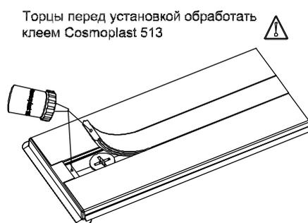
**Телескопическое соединение стоек**
